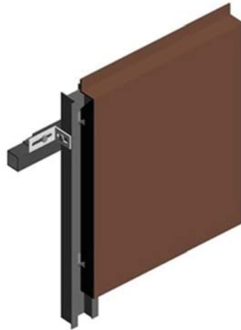
شکل ۸-۴- نمونه ای از روش اجرای هوک
