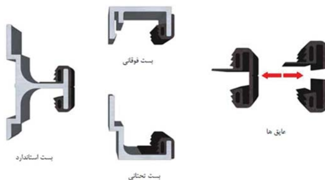
شکل ۷-۱۱- نصب درزپوش بر روی بستها
