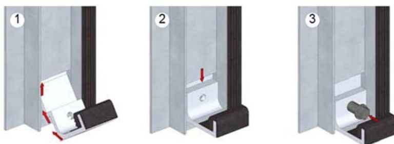
شکل ۷-۱۲- نحوه نصب بستها بر روی ریل
